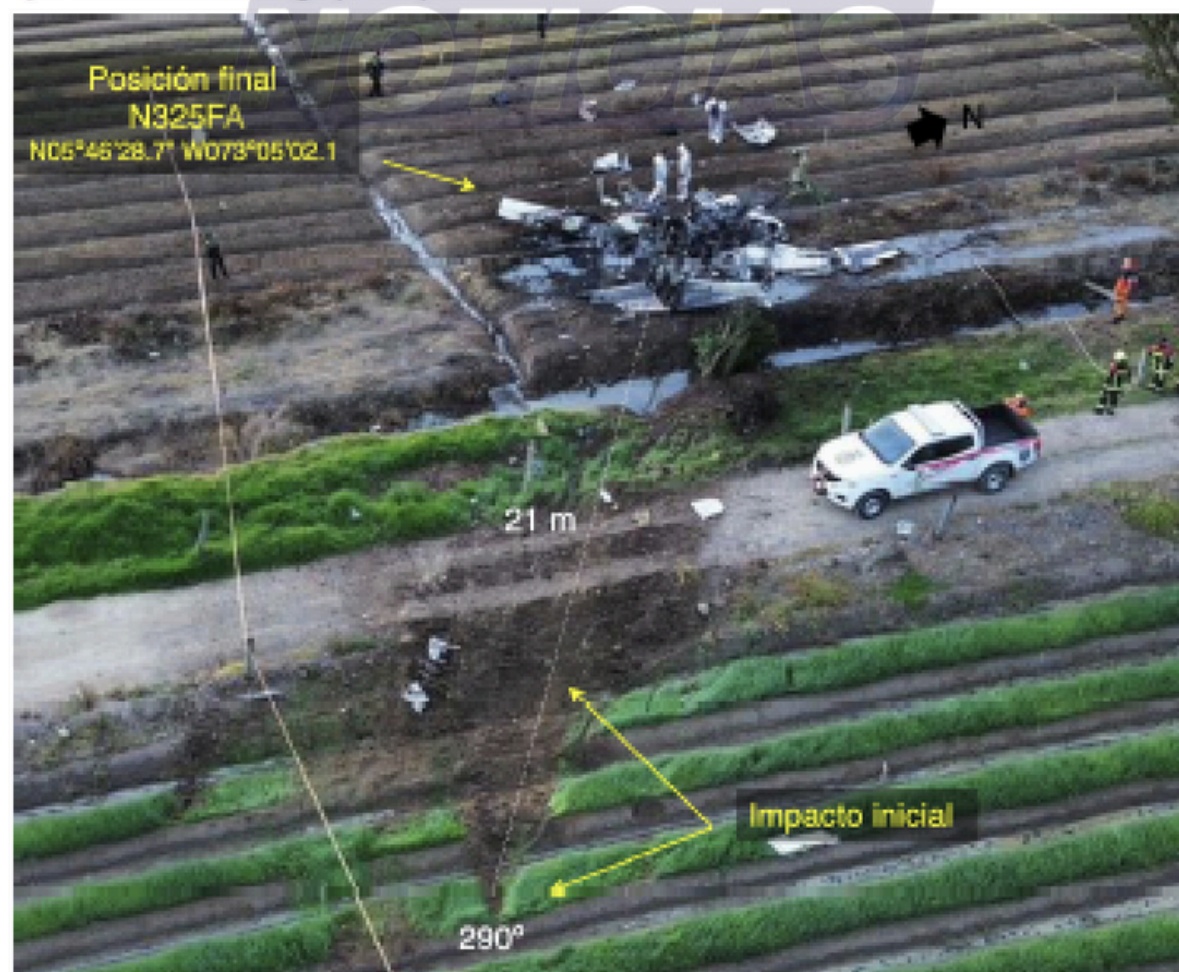
Imagen No.3 – Distribución de restos en la dinámica de impacto N325FA (Fuente: DIACC)
