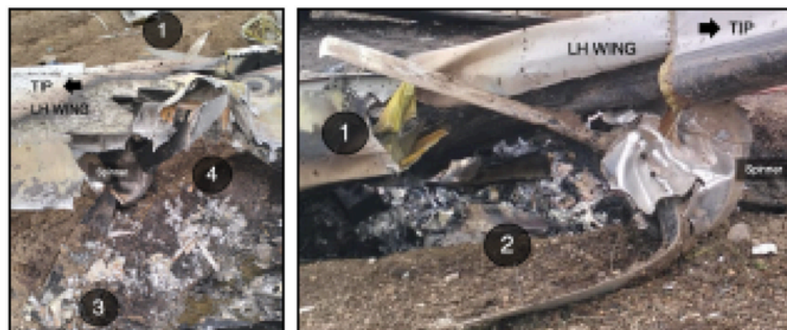
Imagen No. 7 y 8 – Condición de la hélice izquierda en los restos N325FA (Fuente: DIACC)
