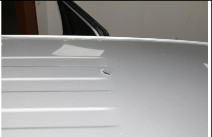
IMAGEN No. 40. Acercamiento de toma anterior, abolladura en techo.
