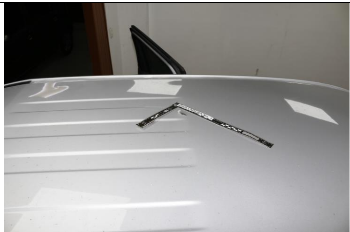
IMAGEN No. 41. Se observa abolladura con testigo métrico.
